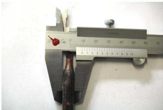
Figures 3 & 4: Frost damage after climate chamber test (EN 12975-2 & TC50)
