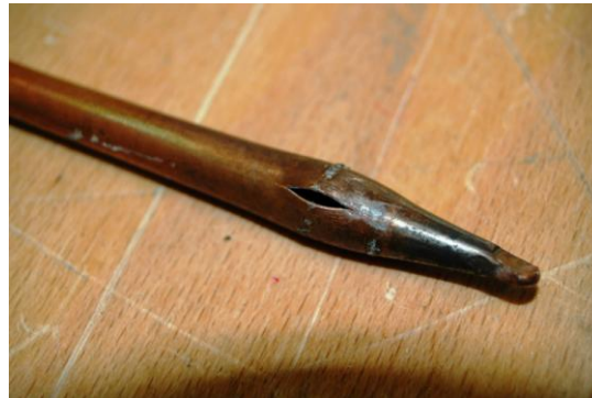
Figures 3 & 4: Frost damage after climate chamber test (EN 12975-2 & TC50)
